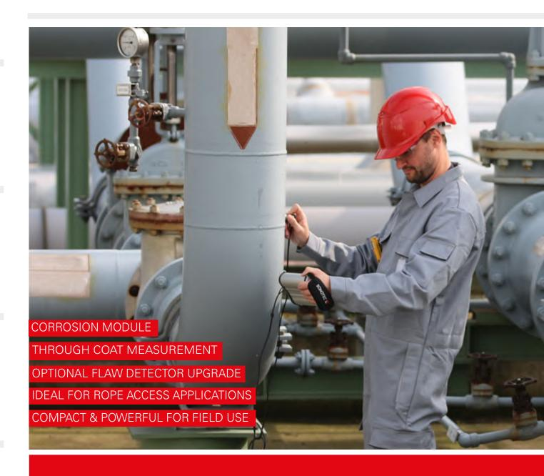
ADVANCED ULTRASONIC A-/B-SCAN WALL THICKNESS GAGE
