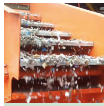
Destoner bei der Verarbeitung von Hausmüll Destoner is processing household waste
