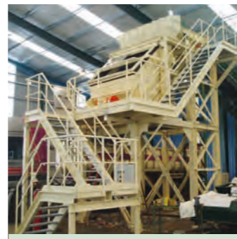
Hartstoffscheider in der Hausmüllaufbereitung Hard particle separator processing domestic waste
