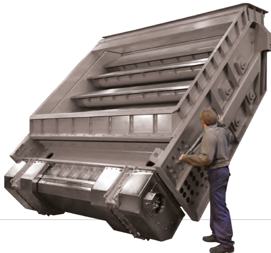
Hartstoffscheider in der Hausmüllaufbereitung Hard particle separator processing domestic waste
