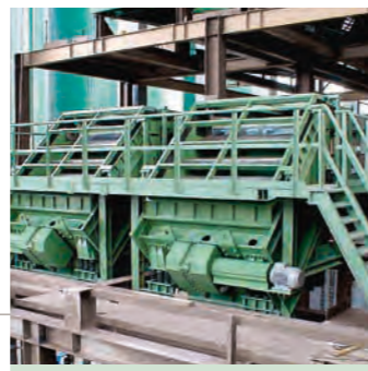
Hartstoffscheider zur Aufbereitung von Gewerbemüll Hard particle separator for processing industrial waste
