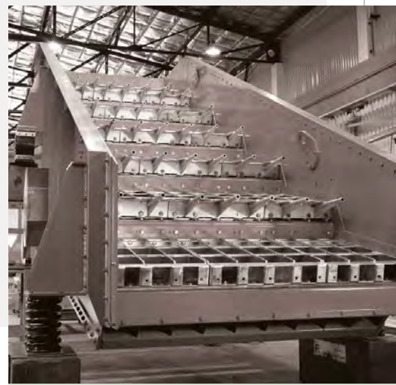
Das Original: ein IFE Müllsieb in der Eindeck-Ausführung The original IFE waste screen in single-deck design
